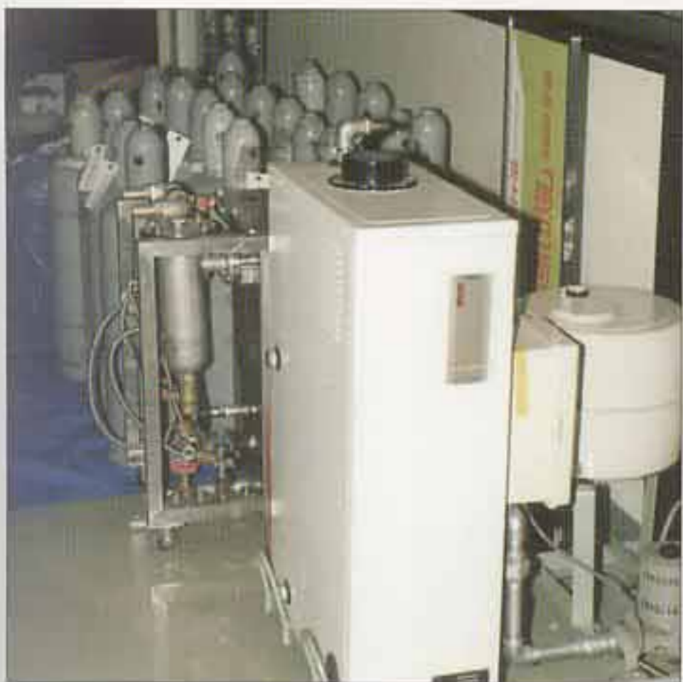
書庫の一斉燻蒸（ガスボンベと気化機）
